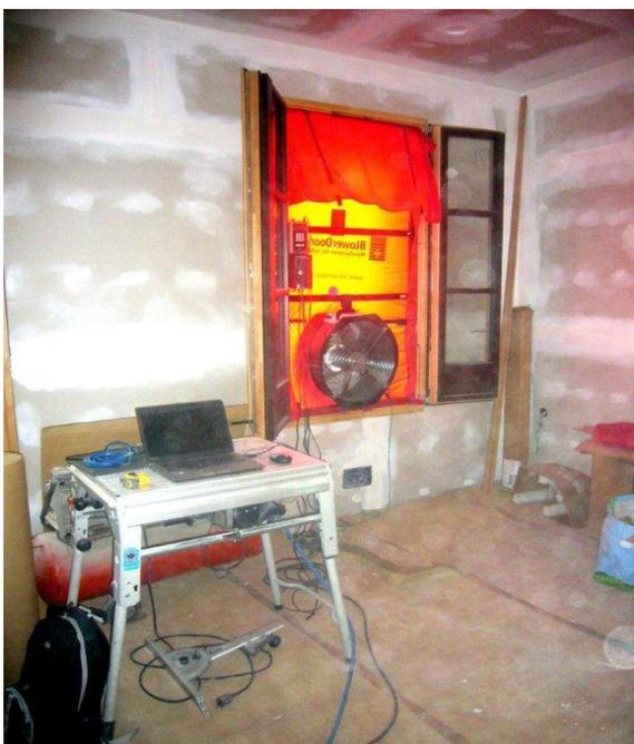
Foto: Test de BlowerDoor – Fuente: Bau Passivhaus
